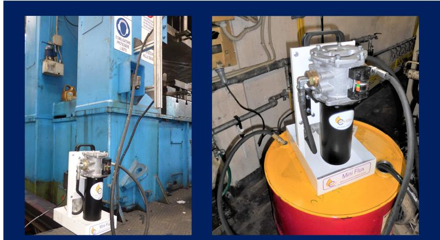
Il Mini Flux 14 Hydraulic è una unità di filtrazione portatile avente due funzioni principali: pre-filtrare il fluido prima o durante la fase di carico nel sistema idraulico e filtrare periodicamente il fluido direttamente sull'impianto, collegando i tubi flessibili di questa unità al serbatoio idraulico.
