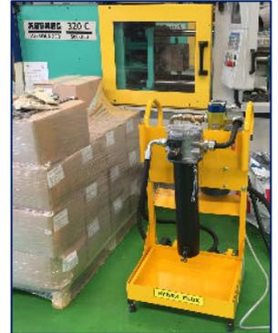
L' Hydraulic Flux 50 è una unità di filtrazione carrellata avente due funzioni principali: pre-filtrare il fluido prima o durante la fase di carico nel sistema idraulico e filtrare periodicamente il fluido direttamente sull'impianto, collegando i tubi flessibili di questa unità al serbatoio idraulico.
