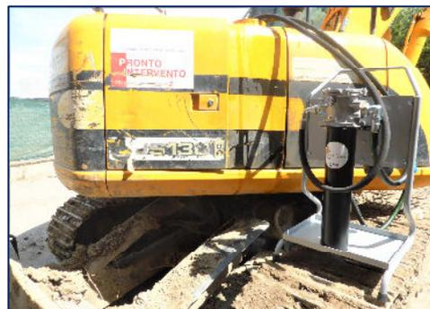
Il Diesel Basic 50 è una unità di filtrazione carrellata avente tre funzioni principali:
