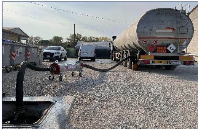
L'Extreme 1000 SS è un filtro carrellato ideale per la filtrazione del gasolio durante la fase di scarico/rifornimento cisterne o trasferimenti di carburante diesel da e per grandi serbatoi.
